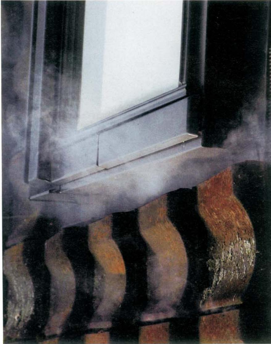
Der Blower-Door-Test bringt es an den Tag: Hier wird für die liebe Luft geheizt. Eine luftdicht ausgeführte Gebäudehülle spart aber nicht nur Energie. Sie sorgt auch für eine langfristig bauschadensfreie Konstruktion.
